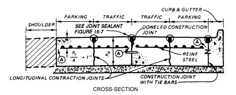
**CONSTRUCTION JOINT** CURB & GUTTER WITH TIE BARS DOWELED CONSTRUCTION -LONGITUDINAL CONTRACTION JOINTS STEEL REINFORCEMENT DOWELED CONTRACTION JOINTS: SHOULDER/ 25 FT MIN - 75 FT MAX PLAN-VIEW
